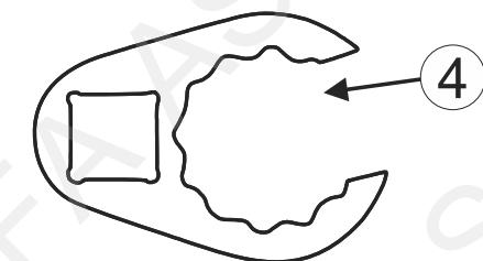
**FI** Lämmitin asennetaan moottorin etupuolelle. Irota ilmaputki (1). Irota alkuperäinen kierteinen tulppa (2) moottorista. Puhdista reikä hyvin ja asenna lämmitin (3) paikalleen. Lämmitimen pistokkeen tulee osoittaa klo. 10. **HUOM!** Lämmitin on helpoin kiristää paikalleen DEFA:n 27mm avosilmukka-avaimella no: **460867** (4). Asenna ilmaputki (1) takaisin paikalleen. Täytä jäähdytysjärjestelmä autonvalmistajan suosittelemalla nesteellä ja ilmaa se ohjeiden mukaan. Tarkista mahdolliset vuodot.
