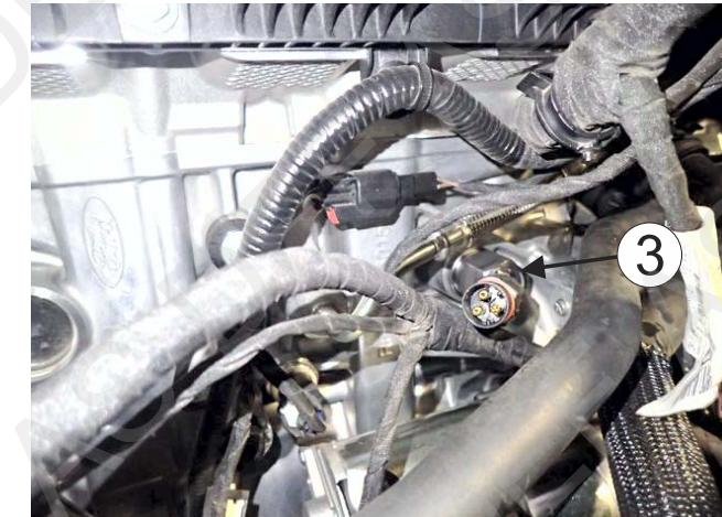
**SE** Värmaren monteras på framsidan av motorn. Demontera lufröret (1). Demontera original gäng plugg (2). **OBS!** Rengör hålet ordentligt och montera värmaren (3). Kontaktens pekande Kl: 10. Använd specialverktyg «Kråkfot» **DEFA 460867** (4) för att dra åt värmaren. Montera tillbaka lufröret (1). Fyll på med godkänd kylvätska och lufta systemet enligt tillverkarens specifikationer. Kontrollera ev läckage.
