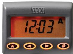
\*Om en utvärdig givare inte finns ansluten visar klockan inte batterispänning och utvärdig temperatur, men alternerar mellan 24 timmars ur - Hämtningstid I - Hämtningstid II med varje ny tryckning på .
