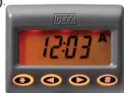
\* Ist der Temperatursensor nicht montiert, wird keine Batteriespannung und keine Außentemperatur angezeigt. Die Anzeige wechselt bei jedem Tastendruck von zwischen 24 Stunden Anzeige oder Abfahrtszeit I oder II.
