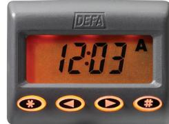
\* Hvis den udvendige sensor ikke er tilkoblet, vil styringsenheden ikke vise batterispænding/ladespænding og udetemperatur, men skifte mellem 24 timers ur - Hentetid I - Hentetid II for hvert tryk på
