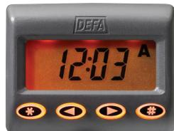
\* Hvis utvendig sensor ikke er tilkoblet vil styringsenheten ikke vise batterispennin/ladespenning og utetemperatur, men veksle mellom 24 timers ur – Hentetid I – Hentetid II for hvert nye trykk på
